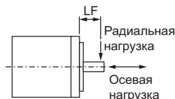
Рис. 6-1 Радиальные и осевые нагрузки двигателя
