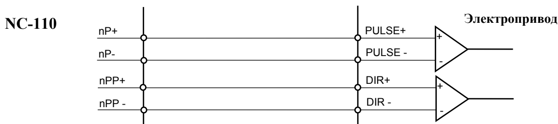
Рисунок 9.14 – Подключение дифференциальных сигналов ЦИП
