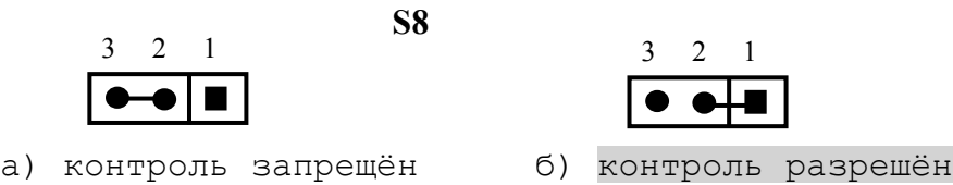
Рисунок 5.4 – Установка аппаратного разрешения контроля обрыва сигналов энкодера
