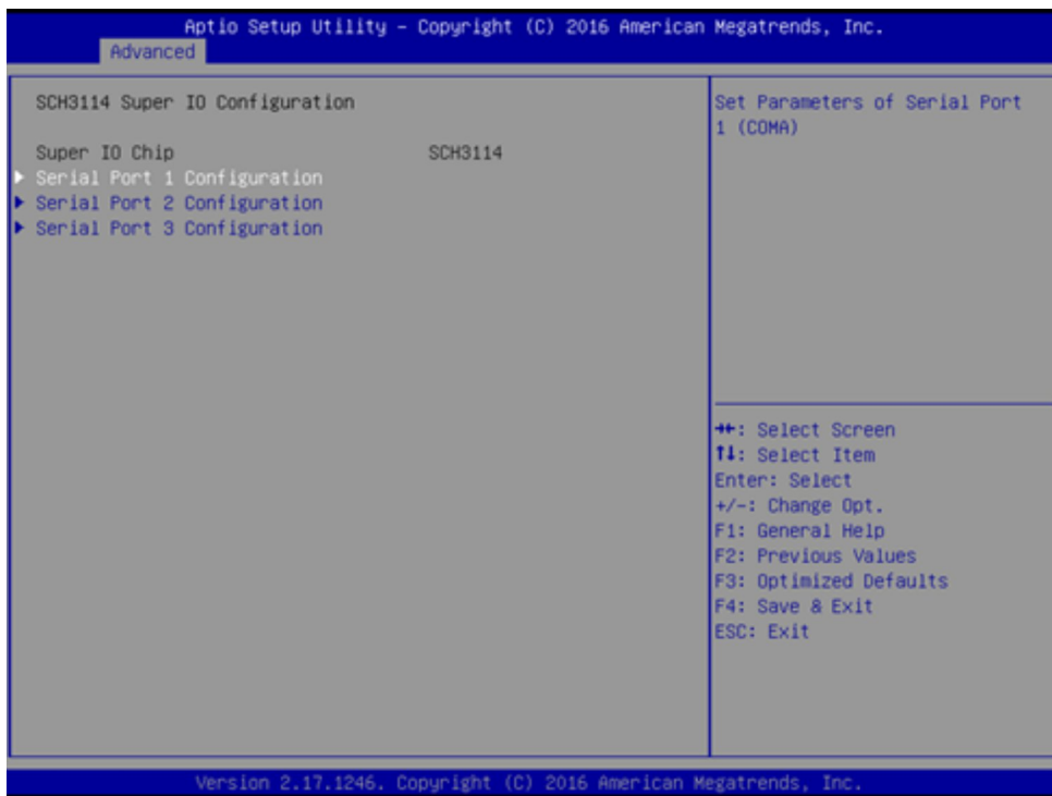
Рисунок Б.4 – Выбор параметра Serial Port 1 Configuration
