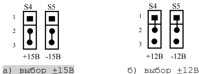
Рисунок 5.7 – Выбор напряжения питания ЦАП
