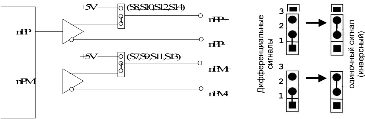
Рисунок 5.22 - Структура выходов канала ЦИП
