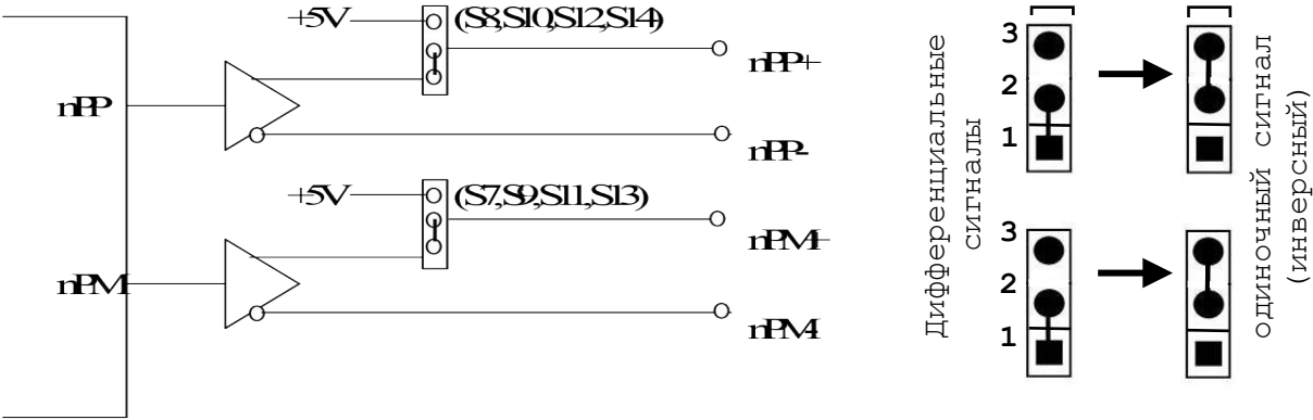
Рисунок 5.25 - Структура выходов канала ЦИП
